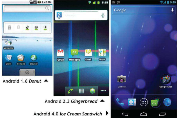
ചിത്രം 5: ആൻഡ്രോയിഡിന്റെ വിവിധ പതിപ്പുകളുടെ സമ്പർക്കമുഖം. മൊബൈൽ ഉപകരണങ്ങളിലെ ഡിസ്ബ്ലൈകളുടെ വലിപ്പം, റെസലൂഷൻ എന്നിവയും ഓരോ പതിപ്പിലും മെച്ചപ്പെടുന്നു. ഉദാഹരണം : വികസിപ്പിച്ചത്
